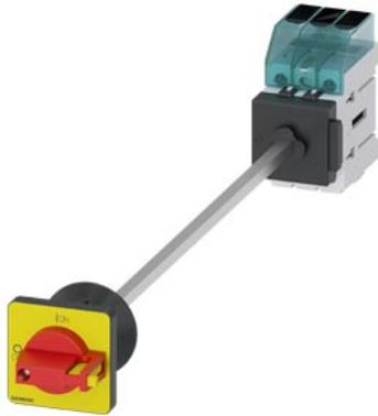
Lasttrennschalter 3LD3, Iu 32 A Hauptschalter 3-polig Bemessungsbetriebsleistung bei AC-23 A bei 400V 11,5kW Bodenbefestigung Basisschalter mit Tuerkupplung Zentrallochbefestigung 22,5mm Knebelantrieb rot/gelb 48x48 mm
