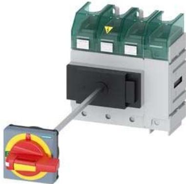
SENTRON, Lasttrennschalter 3LD5 UL, Not-Aus-Schalter, 4-polig, approbiert nach UL489, UL60947-4-1 und IEC60947-3, UL: 150A, SCCR 50kA at 480VAC, Betriebsleistung @ 480VAC 3-phasig: 100hp, IEC: 160A, Betriebsleistung bei AC-23A bei 400V: 75kW, Bodenbefestigung mit Türkupplung, überlistbarer Drehantrieb, NOT-AUS, 4-Loch Befestigung der Handhabe, ohne Toleranzausgleich inklusive Klemmenabdeckungen für die Einspeiseseite
