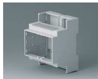
B6703102 RAILTEC C, 4 Module, Ausf. II PC (UL 94 V-0) lichtgrau 71x90x58mm
