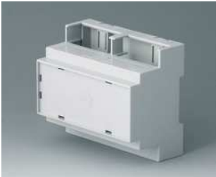
B6705107 RAILTEC C, 6 Module, Ausf. IV PC (UL 94 V-0) lichtgrau 106x90x58mm
