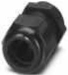
Kabelverschraubung, Material Verschraubung: PA, Kabelaußendurchmesser 13 mm ... 18 mm, Schirmung: nein, Anschlussgewinde: M25 x 1,5, Farbe: tiefschwarz RAL 9005
