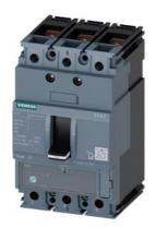
Leistungsschalter 3VA1 IEC Frame 160 Schaltvermögenklasse S Icu=36kA @ 415V 3-polig, Anlagenschutz TM220, ATFM, In=16A Überlastschutz Ir=11A...16A Kurzschlussschutz Ii=20 x In Schraubenflachanschluss
