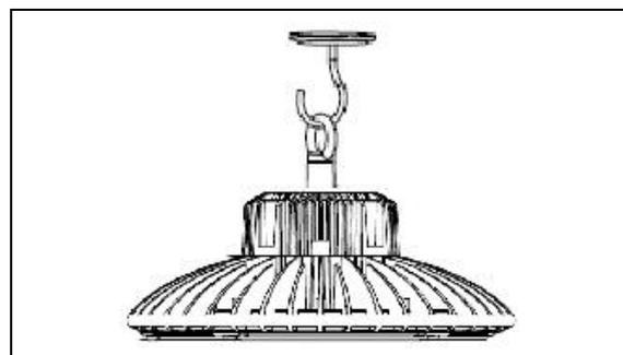
Hängen Sie die Leuchte an die Decke und sichern Sie die Leuchte mit dem Sicherungsseil.
