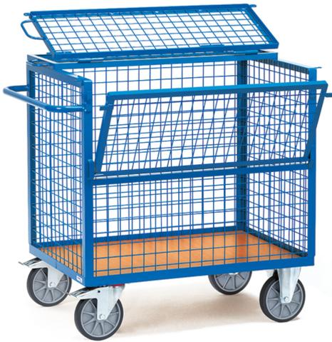
Stahlrohr und Profilstahl geschweißt, pulverbeschichtet blau RAL 5007. Boden aus Holzwerkstoffplatte, Oberfläche Buchendekor. Winkelstahl-Konstruktion. Drahtgitter 50 x 50 x 4 mm eingeschweißt. Deckel aus Drahtgitter, 2-fach klappbar. Ringösen für Vorhängeschlösser. 2 Lenk- und 2 Bockrollen, TPE-Bereifung, Naben mit Rillenkugellager. Feststeller an den Lenkrollen, gemäß der Europäischen Norm EN 1757-3 (Sicherheit von Plattformwagen). Zerlegte Anlieferung. Nutzhöhe: 806 mm.
