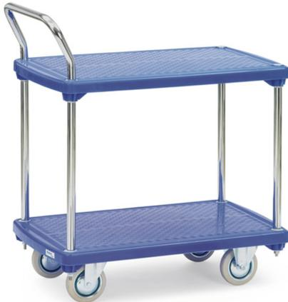
Tischwagen mit 2 Etagen. Plattformen aus Kunststoff gespritzt mit rutschhemmender Oberfläche. Rohrschiebebügel feststehend, glanzverzinkt. 2 Lenk- und 2 Bockrollen, Vollgummibereifung blaugrau spurlos. Gesamthöhe 890 mm. Feststeller an den Lenkrollen, gemäß der Europäischen Norm EN 1757-3. Zerlegte Anlieferung. x000D\_Tragkraft obere Ladefläche 80 kg.
