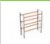
rayonnage à palettes - rayonnage départ, hauteur x largeur x profondeur 3300 x 2870 x 1100 mm, charge max. par tablette 1550 kg, 3 niveaux avec traverses, 12 emplacements (lisse incl.), entreposage longitudinal, force par palette 500 kg, montants avec revêtement en zinc anti-corrosion, traverses avec finition époxy résistante aux chocs et aux rayures en RAL2001 orangé rouge
