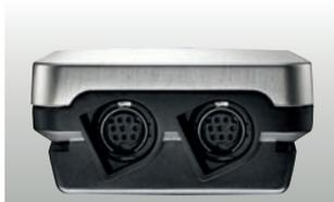
Fühleranschlüsse am unteren Gehäuseende für zwei Temperatur-/Feuchtefühler
