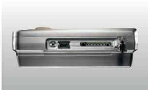
Seitlicher Anschluss von Mini-USB-Kabel und SD-Karte
