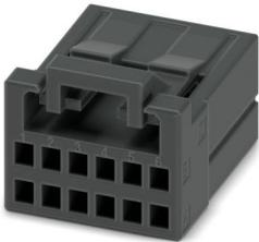
Leiterplattenstecker, Farbe: schwarz, Nennstrom: 5 A, Bemessungsspannung (III/2): 160 V, Kontaktart: Buchse, Anzahl der Reihen: 2, Polzahl: 12, Artikelfamilie: DD21PC 0,85/..., Rastermaß: 2,5 mm, Anschlussart: Crimpanschluss, Anschlussrichtung Leiter/Platine: 0 °, Rasthaken: - ohne Rasthaken, Stecksystem: CONNEXIS DD, Verriegelung: Rastverriegelung, Befestigungsart: Rastflansch, Verpackungsart: verpackt im Karton
