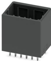
Leiterplatten-Grundleiste, Farbe: schwarz, Nennstrom: 5 A, Bemessungsspannung (III/2): 160 V, Kontaktoberfläche: Zinn, Kontaktart: Stift, Anzahl der Reihen: 2, Polzahl: 12, Artikelfamilie: DD21H 0,85/..-V, Rastermaß: 2,5 mm, Montage: Wellenlöten, Pin-Layout: Lineares Pinning, Pinlänge [P]: 3,4 mm, Anzahl der Lötpins pro Potenzial: 1, Stecksystem: CONNEXIS DD, Ausrichtung Steckgesicht: Standard, Verriegelung: Rastverriegelung, Befestigungsart: Rastnase, Verpackungsart: verpackt im Karton
