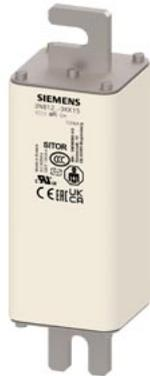
SITOR-Sicherungseinsatz Baugröße 2 200A aR 1000V dc/1250V VSI 1100V dc UL @MBC 7xIn Schraubkontakte M10 170mm geschlitzte Messer
