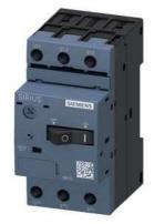
Leistungsschalter Baugröße S00 für den Motorschutz, CLASS 10 A-Auslöser 4,5...6,3 A N-Auslöser 82 A Schraubanschluss Standardschaltvermögen
