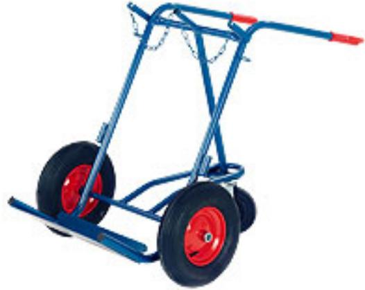
Stahlflaschenkarre ist unentbehrlich für das Schweißen im mobilen Einsatz. Oberfläche: pulverbeschichtet enzianblau (RAL 5010) Tragkraft: 150 kg Stützrad: Lenkrolle (ø 200 x B 50 mm), Vollgummi, Rollenlager Flascheninhalt: 2x 40 - 50 Liter Flaschendurchmesser: 210 - 250 mm Außenmaße: (B/T): 840 x 900 mm Vollgummireifen: 400 x B 80 mm, Gewicht 49 kg Luftreifen: 400 x B 100 mm, Gewicht 12,5 kg
