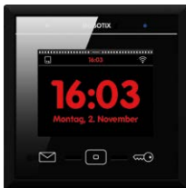
Abb.: Nach der Autokonfiguration wird das MxDisplay+ im Standby-Modus mit Datum- /Uhrzeitanzeige geöffnet.
