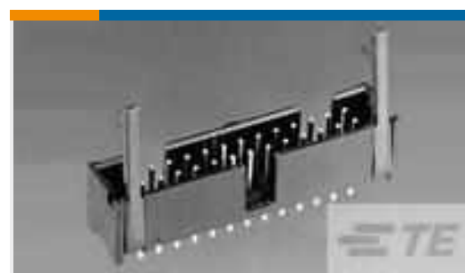
TE Teilnr.:2-1761609-3 IDC LOW PRO HDR 10P RA SHT LAT
