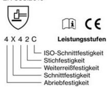
Piktogramm und Leistungsstufen nach EN 388 : 2016 (höchste Leistungsstufe: 4, bei Schnittfestigkeit: 5, bei ISO-Schnittfestigkeit: F)
