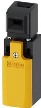
Sicherheits-Positionsschalter mit getrenntem Betätiger Kunststoffgehäuse, 31 mm Geräteanschluss 1x (M20x 1,5) Schleichschaltglieder 2Ö/1S, 5 Anfahrrichtungen Auszugskraft 30 N, der dazu passende getrennte Betätiger 3SE5000-0AV0. muss separat bestellt werden
