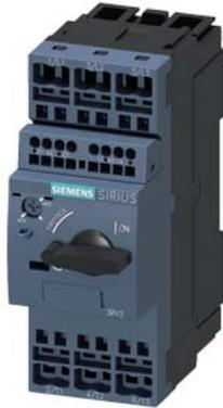
Leistungsschalter Baugröße S0 für den Motorschutz, CLASS 10 A-Auslöser 5,5...8 A N-Auslöser 104 A Federzuganschluss Standardschaltvermögen mit querliegenden Hilfsschalter 1S+1Ö
