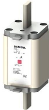
NH-Sicherungseinsatz, NH1, In: 200 A, gG, Un AC: 690 V, Un DC: 440 V, Kombikennmelder, isolierte Griffflaschen
