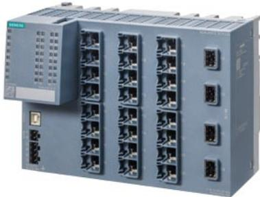
SCALANCE XCH328 managed Layer 2 IE Switch, 24x 10/100/1000 Mbit/s RJ45, 4x 1/10 Gbit/s SFP+ Port, LED- Diagnose, Fehlermeldekontakt mit Select/Set-Taster, PROFINET IO Device, Netzwerk- Management, Redundanzfunktionen, Office Features (RSTP, VLAN, IGMP,..) CLP im Lieferumfang Montage: Hut-/S7-Profileschiene Conformal coating
