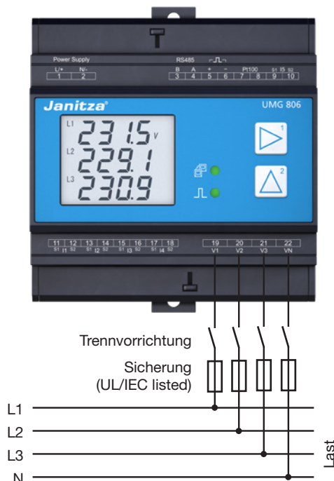
Abb. Anschlussbeispiel „Spannungsmessung“.
