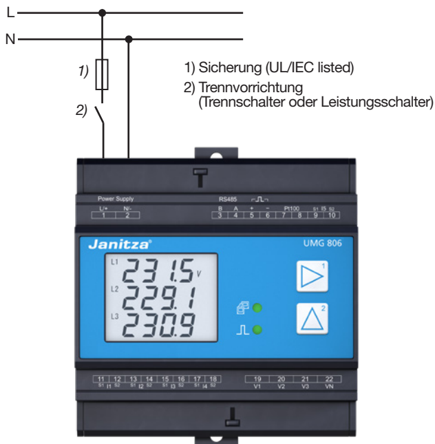
Abb. Anschluss Versorgungsspannung.
