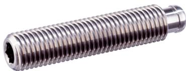
Gewindestifte sind Spannschrauben, die über den Druckzapfen Kräfte direkt übertragen können. Die Druckfläche des Druckzapfens der Stahl-Ausführung ist gehärtet.
