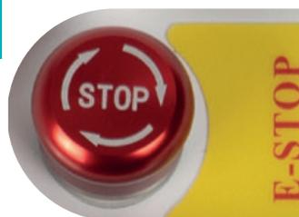
Nachdem die Karte nun programmiert ist, **drehen** Sie den NOT-AUS-Knopf **bei gleichzeitig leichtem Ziehen** im **Uhrzeigersinn**, um ihn wieder in die Ursprungslage zu versetzen.
