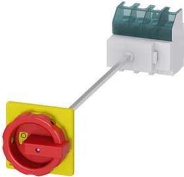
SENTRON, Lasttrennschalter 3LD, Not-Aus-Schalter, 4- polig, Iu: 63 A, Betriebsleistung / bei AC-23 A bei 400V: 22 kW, Bodenbefestigung mit Türkupplung, Drehantrieb, rot/gelb, 4-Loch Befestigung der Handhabe
