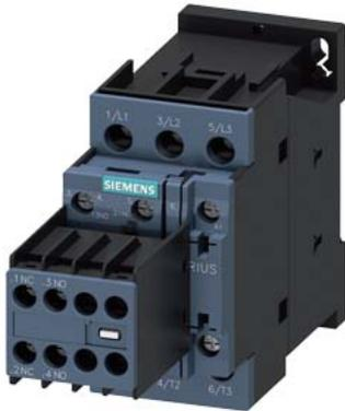
Leistungsschütz, AC-3e/AC-3, 32 A, 15 kW / 400 V, 3-polig, AC 230 V, 50/60 Hz, Hilfskontakte: 2 S + 2 Ö, Schraubanschluss, Baugröße: S0, Hilfsschalter lösbar
