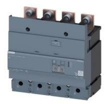
Differenzstrom-Schutzgerät RCD820 advanced RCD Typ A unten angebaut Bemessungsfehlerstrom 0,03..30A bei 50/60Hz einstellbare tv 0...10000ms 4-polig In=400A Ue=100-690V Zubehör für: 3VA2
