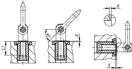
Douille de logement plate pour anneau de levage à broche en Inox, forme
