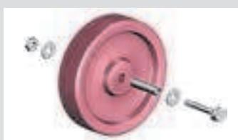
6491.513 Rad inklusive Achse für 1260.200 Gew. 1,1 kg, Ø 150 mm.
