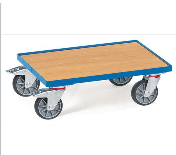
Construction en profilé d'acier, revêtement époxy bleu RAL 5007. Rouleur avec plateau en mélaminé avec rebord de 10 mm. 4 roues pivotantes à bandage TPE, moyeu à roulement à billes central. 2 roues avec freins conformément à la Norme EN 1757-3. Compatible pour bacs plastiques 600 x 400 mm.
