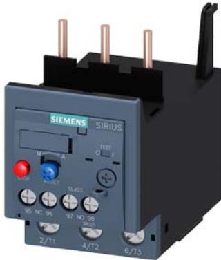
Überlastrelais 14...20 A thermisch für Motorschutz Baugröße S2, CLASS 10
