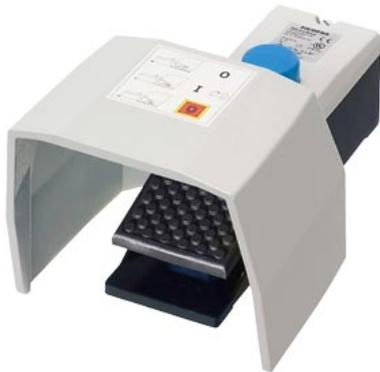
Sicherheits-Fußschalter 1-pedalig, mit Schutzhaube, IP65, mit Verriegelungsfunktion, 2S+2Ö, Schließer, schließt als Taster, Öffner, öffnet mit gleichzeitiger Rastung ( Sicherheitsfunktion), Leitungseiführung M20 x 1,5
