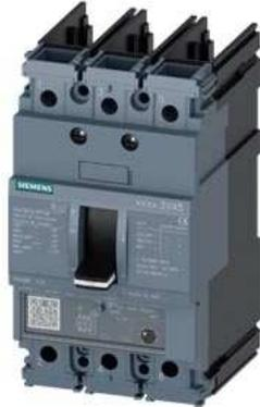
Leistungsschalter 3VA5 UL Frame 125 Schaltvermögenklasse M 35kA @ 480V 3-polig, Anlagenschutz TM240, ATAM, In=30A Überlastschutz Ir=24A...30A Kurzschlusschutz Ii=5...10 x In ohne Anschluss
