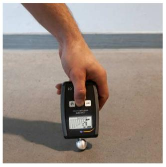
Materialfeuchtemessgerät mit verschiedenen Menüsprachen / Anzeige digital drehbar / automatische Abschaltung zur Batterieschonung / für Beton und Holz
