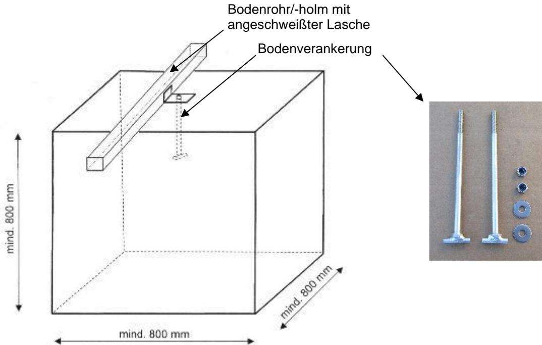
b) **Draufsicht Bodenverankerung Mini-Bolzplatztor 1,20 x 0,80 m:**
