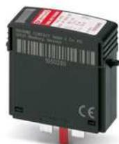
Überspannungsschutzstecker Typ 2 mit Reihenschaltung aus Varistor und gasgefüllter Funkenstrecke für VAL-MS-Basiselement, thermisch überwacht, optische Defektmeldung. Ausführung: 350 V AC mit erhöhtem Blitzstrom-Ableitvermögen.
