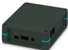
Komplettgehäuse für Leiterplatten. Beinhaltet Gehäusehalbschalen, Seitenwände mit Öffnungen für alle relevanten Anschlüsse, Klebedome zur Befestigung des Raspberry Pi Model B2 und B3 Computers, Schrauben für Gehäuse und Platinenbefestigung; Gehäusefarbe schwarz mit Eckenlegern türkisblau
