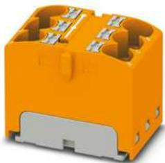
Verteilerblock, die Blöcke sind untereinander über den Leiterschacht brückbar, passende Steckbrücken siehe Zubehör, intern gebrückt, Nennspannung: 450 V, Nennstrom: 32 A, Anschlussart: Push-in-Anschluss, Querschnitt: 0,2 mm<sup>2</sup> - 6 mm<sup>2</sup>, Montageart: kleben, Farbe: orange
