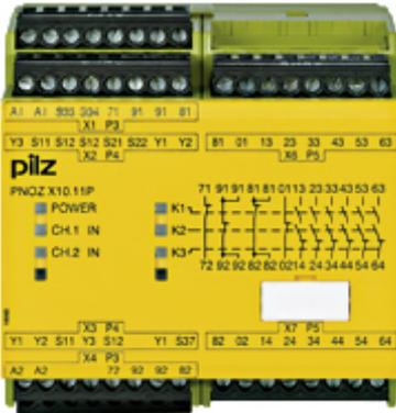
Sicherheitsschaltgerät (standalone), Eingänge: 1/2-kanalige Beschaltung mit/ohne Querschlusserkennung, Ausgänge: 6 S, 4 Ö, automatischer/überwachter Start, UB = 24 V DC, Breite: 90 mm, steckbare Schraubklemmen, Überwachung von Not-Halt, Schutztüren, Lichtgitter, seitenkompatibel zu PNOZ X10.1.
