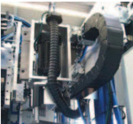
igus® E2 E-Rohr und Triflex® R in einem Bearbeitungszentrum
