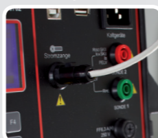
Anschluss für externen Stromzangenadapter (optional Beha-Amprobe CHB 1) zur Messung von Schutzleiterströmen auch an 3-phasigen Prüflingen (nur GT-800)
