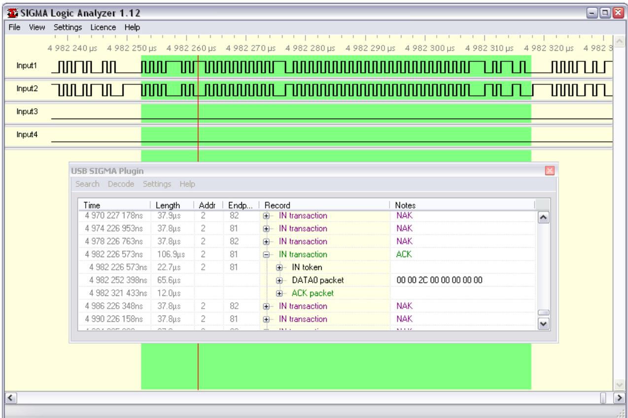
Fig. 12: DATA0 packet highlighted
