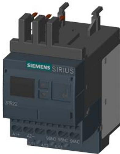
UEBERWACHUNGSRELAIS ANBAUBAR AN SCHUETZ 3RT2, BAUGROESSE S00 STANDARD, DIGITAL EINSTELLBAR SCHEIN-/WIRKSTROMUEBERWACHUNG 1,6 - 16A, 20-400 HZ, 3-PHASIG VERSORGUNG 24-240 V AC/DC 1 WECHSLER, 1 HALBLEITERAUSGANG FUER ALARM UND WARNUNG UEBERWACHUNG AUF STROMUEBER- U. UNTERSCHREITUNG PHASENAUSFALL, DRAHTBRUCH PHASENFOLGE FEHLERSTROM BLOCKIERSTROM WARNUNG UND ALARMSCHWELLEN MIT ODER OHNE FEHLERSPEICHER ANLAUFVERZOEGERUNG 0-99 S STOERSPITZENAU BLEND. 0-30 S PAUSE NACH FEHLER 0-300 MIN FEDERZUGTECHNIK
