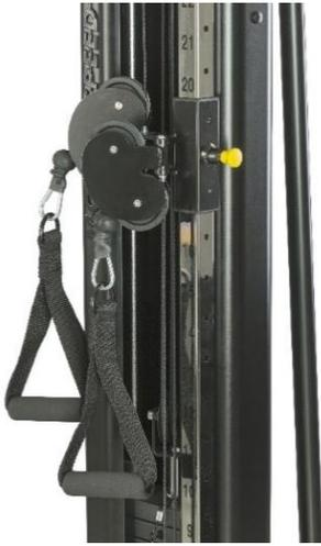
*Immagine 17. Einstellrohr und Höheneinstellung (oberer Rollenrahmen)*
