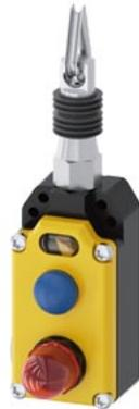
Sicherheits-Seilzugschalter Metallgehäuse, 2 xM20x1,5; mit gelbem Deckel, mit Rastung nach EN ISO 13850 Druckknopfentriegelung, mit LED Lampe 24 V DC, rot, für Seillängen bis 20 m
