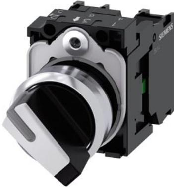
Knebelschalter, beleuchtbar, 22 mm, rund, Metall, hochglanz, weiß, Knebel, kurz, 2 Schaltstellungen O-I, verrastend, Schaltwinkel 90°, 10:30h/13:30h, mit Halter, 1S, 1Ö, Schraubanschluss
