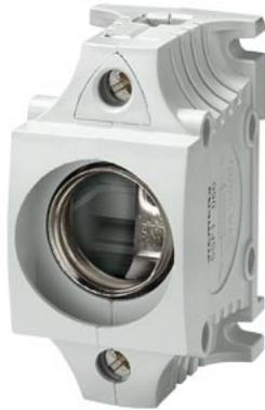
DIAZED-Sicherungssockel Größe III Formstoff, 1-polig berührungsgeschützt (BGV A2) Zugang: Doppelfunktionsklemme Abgang: Rahmenklemme 63A AC 500V
