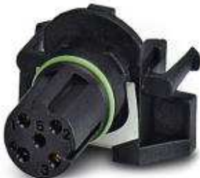
Bus-System-Einbaubuchse, Ethernet, 4-polig, geschirmt, D-kodiert, mit geradem Lötanschluss, nur Kontakteinsatz
