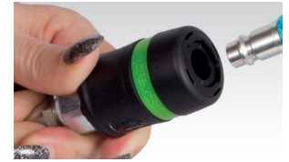
Sicherheits-Schnellkupplung: Ein Zug nach unten und die Druckluft wird abgelassen. Ein Schub nach oben und der Stecknippel wird sicher entkoppelt
