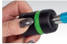
Sicherheits-Schnellkupplung: Ein Zug nach unten und die Druckluft wird abgelassen. Ein Schub nach oben und der Stecknippel wird sicher entkoppelt
