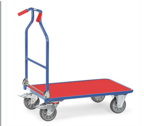
Stahlrohr-Konstruktion, pulverbeschichtet, dauerhaft oberflächengeschützt, schlag- und kratzfest. Holzwerkstoffplatte mit roter Kunststoffoberfläche. Schiebebügel auf Plattform klappbar. 2 Lenk- und 2 Bockrollen, TPE-Bereifung, Naben mit Rillenkugellager. Feststeller an den Lenkrollen, gemäß der Europäischen Norm EN 1757-3 (Sicherheit von Plattformwagen).
